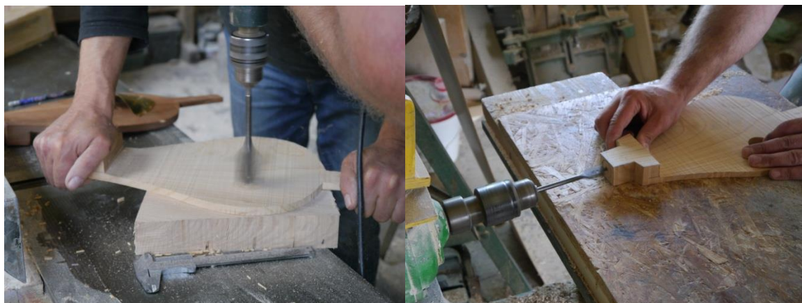
RYS. 28 WIERCENIE OTWORÓW DYMLOKA (OPRACOWANIE WŁASNE)
